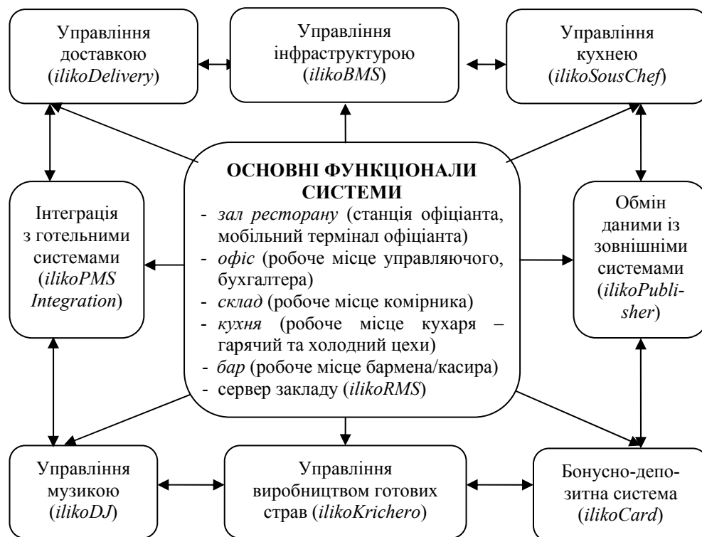
Рис. 5. Схема автоматизації системи управління на ЗРГ з використанням АСУ "ilikoRMS" (розроблено автором на основі [21])
