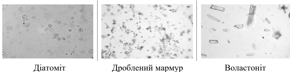
Рис. 1. Фото оптичної мікроскопії мінеральних наповнювачів (збільшення 40×)
