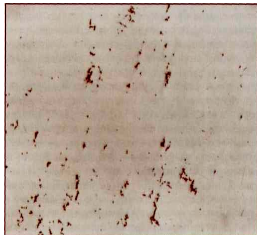
Рис. 2. Невідповідність температури розплаву та лиття
