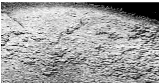
Рис. 5. Шорсткувата (зерниста, або піщана) поверхня виробу
