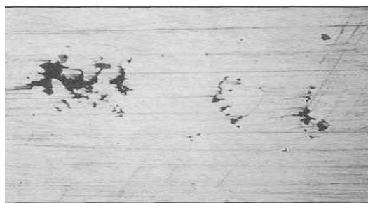
Рис. 8. Поверхнева пористість, викликана домішками оксиду цинку
