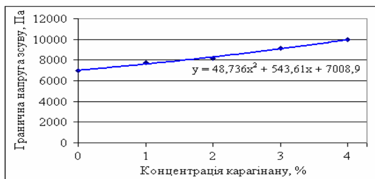
Рис. 6. Гранична напруга зсуву тістових мас залежно від концентрації карагінану
