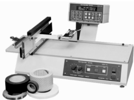
Рис. 1. Промисловий прилад Coesfeld Friction Tester для визначення коефіцієнта тертя полімерних матеріалів
