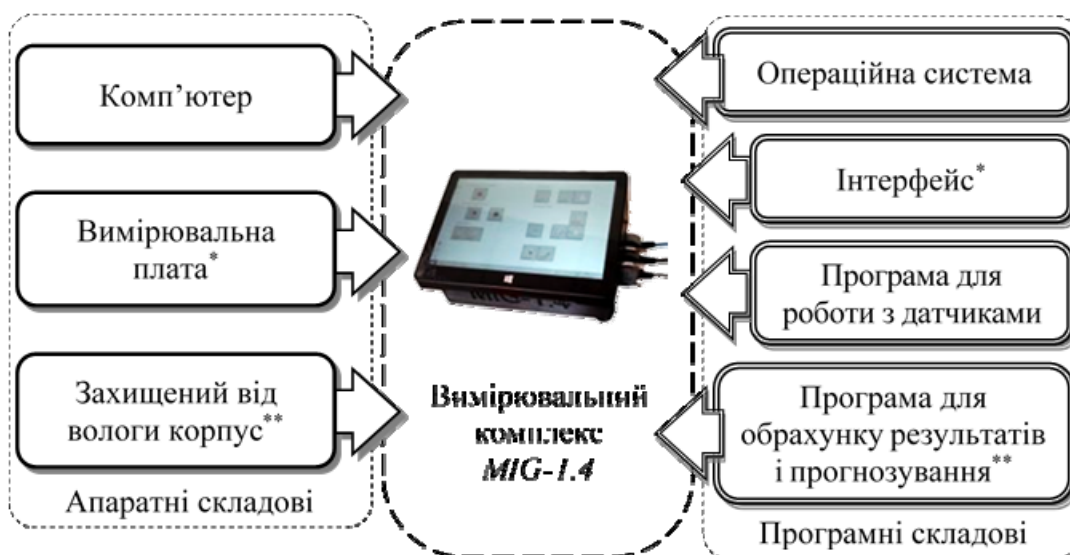
Рис. 5. Схема виготовлення багатофункціонального вимірювального комплексу MIG-1.4
