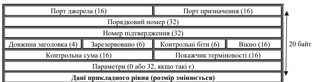
Рис. 2. Поля заголовка TCP [13]
