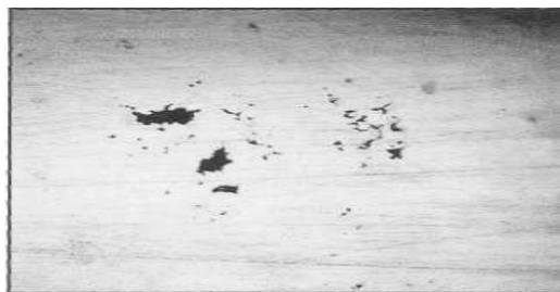
Рис. 2. Мікроріз деталі виробу з газовою пористістю, викликаною домішками (100-кратне збільшення)
