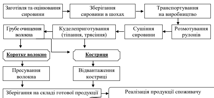
Рис. 3. Технологічна схема первинної переробки стебел льону олійного на основі модернізованого КПАЛ (Україна)
