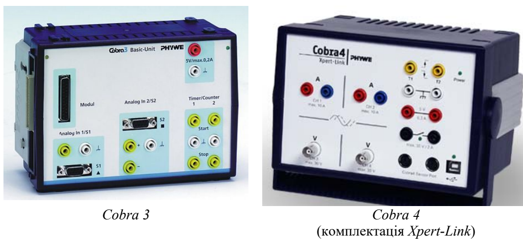
Рис. 3. Багатофункціональні вимірювальні комплекси компанії Phywe
